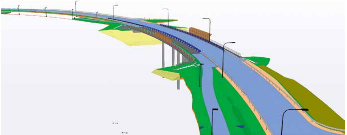
Tulevane Rail Baltica raudtee hakkab kulgema Põrguvälja tee alt läbi, mille jaoks rajatakse sinna viadukt ja tehnosüsteemid.
